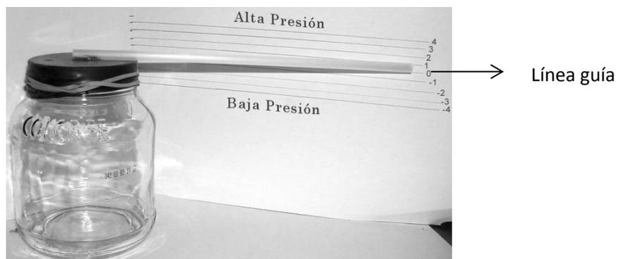
Figura 19. Construcción del barómetro
